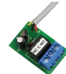
RE02 Zur Bereitstellung eines potential- freien Ausgangs (2A/24V)
