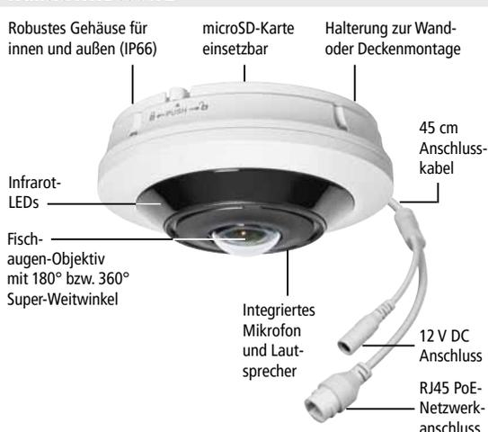
Robustes Gehäuse für innen und außen (IP66) | microSD-Karte einsetzbar | Halterung zur Wand- oder Deckenmontage
