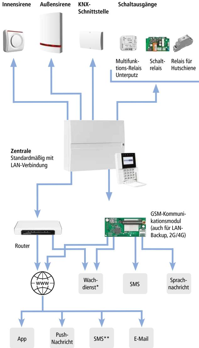
\* Hinweis: Bis zu vier Alarmempfangsstellen können über SIA-IP oder Contact ID Protokolle aufgeschaltet werden. Bei Datenübertragung über GSM muss eine Full-Rate Channel-Verbindung vom Provider vorhanden sein. Bei gleichzeitiger Nutzung der App und einer AES muss diese über einen passenden Empfänger mit Schnittstelle zu App verfügen.
