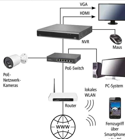
Direkter Zugriff auf den NVR ermöglicht die Betrachtung von Livebildern und gespeicherten Daten aller angeschlossenen Kameras.
