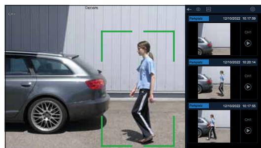
Bei INDEXA Netzwerkkameras mit integrierter künstlicher Intelligenz (KI) können Menschen/Fahrzeuge erkannt werden, um bei Erfassung Aufnahmen zu starten bzw. Benachrichtigungen zu senden.
