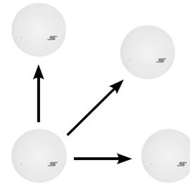
Bis zu insgesamt 12 Funk-Melder können miteinander vernetzt werden. Bei Raucherkennung durch einen Melder alarmieren alle vernetzten Melder, die sich innerhalb der Funkreichweite des auslösenden Geräts befinden. Nur Melder innerhalb einer Wohneinheit dürfen vernetzt werden.
