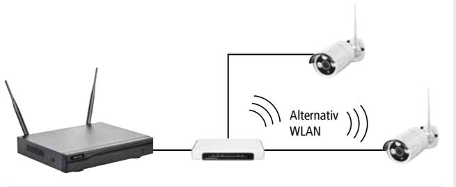
Einsatz eines WR100E (optional erhältlich) als WLAN\*-Repeater:
