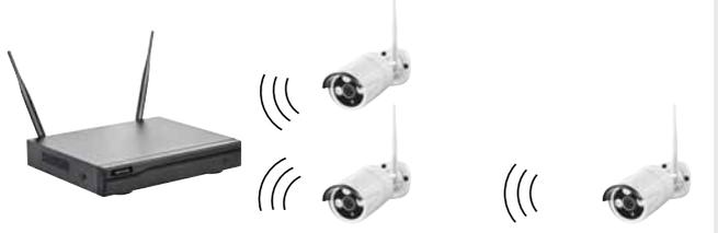
Kamera auch als WLAN\*-Repeater einsetzbar (bis zu 3 Kameras in Reihe)
