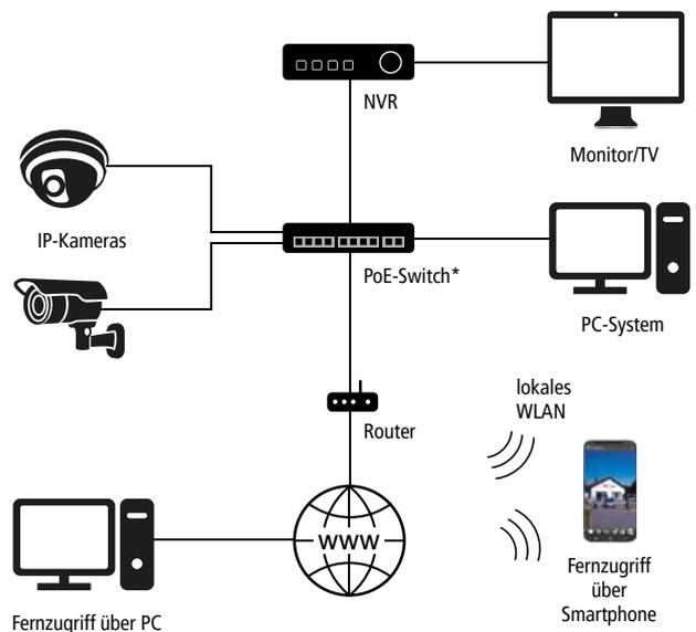
\* PoE-Switch nicht notwendig bei NVR mit integrierter PoE-Funktion.
