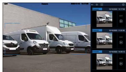
Bei INDEXA Netzwerkcameras mit integrierter künstlicher Intelligenz (KI) können Menschen/Fahrzeuge erkannt werden, um bei Erfassung Aufnahmen zu starten bzw. Benachrichtigungen zu senden.
