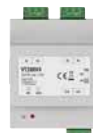
VT200V4 Art.Nr. 28362 4-facher Verteiler in REG-Gehäuse Ermöglicht Verteilung auf 4 Stichleitungen für je bis zu 2 In- nenstationen. Auch erforderlich bei An- schluss von mehr als einer Türsprechstelle im System.
