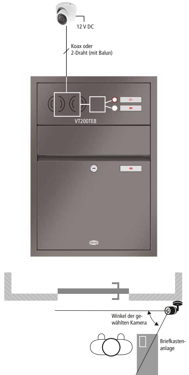
Extrabreite Türsprechstelle zur Unterputzmontage für bis zu 2 Wohneinheiten. Geeignet, um Öffnungen für breite Türsprechstellen alter Markenanlagen abzudecken. Abmessungen Frontplatte: 172 x 226 x 2 mm
