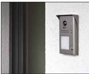
Untergeordnete Aufputz-Türsprechstelle VT200TAX1 für eine Wohneinheit, als Erweiterung zu einer Hauptsprechstelle mit bis zu 4 Ruf-tasten. Verwendbar mit Innenstation VT200MB2 (nicht mit VT200MW2).
