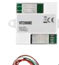
VT200RE Art.Nr. 28373 Ruftastenerweiterung Schnittstelle für den An- schluss von bis zu 8 weiteren Ruftasten an VT200TE8. Bis zu 32 Ruftasten können im System betrieben werden. Kabelverbindungen für Schließerkontakte (NO). Durchschleifanschluss über Flachbandkabel an der Tür- sprechstelle bzw. an weite- ren Schnittstellen.
