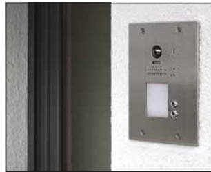
Extrabreite Türsprechstelle zur Unterputzmontage für bis zu 2 Wohneinheiten. Geeignet, um Öffnungen für breite Türsprechstellen alter Markenanlagen abzudecken. Abmessungen Frontplatte: 172 x 226 x 2 mm
