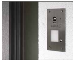
Untergeordnete Unterputz-Türsprechstelle VT200TUX1 für eine Wohneinheit, als Erweiterung zu einer Hauptsprechstelle mit bis zu 4 Ruf-tasten. Verwendbar mit Innenstation VT200MB2 (nicht mit VT200MW2).
